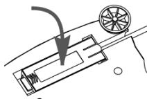
3. Das Schnittstellenmodul installieren.
