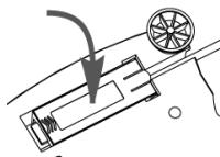
3. Installare il modulo di interfaccia.
