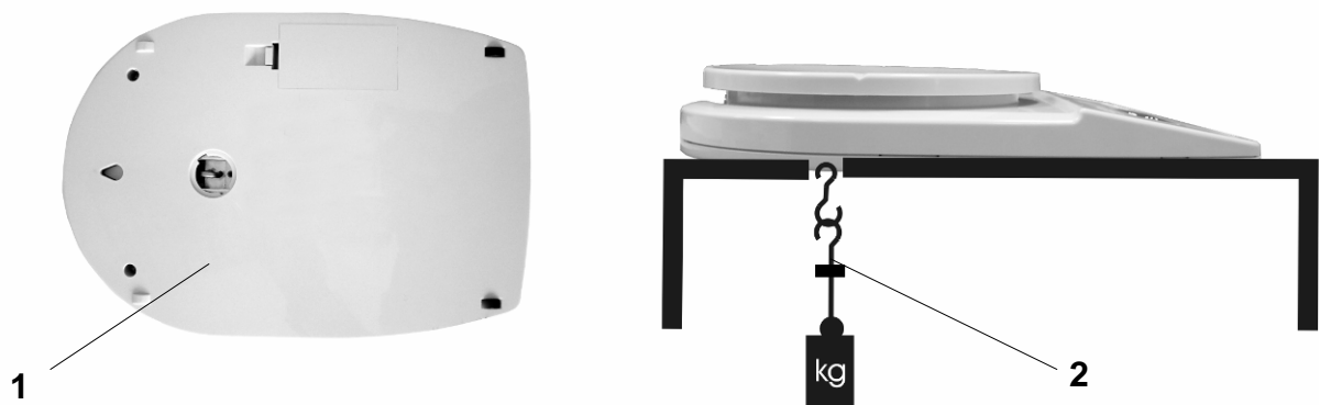
Fig. 1: Uppställning av vågen för vägning under vågen.
